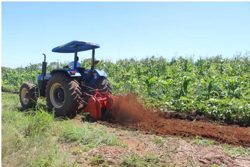
**Enxada rotativa subsoladora**, que prepara rapidamente grandes extensões de canteiros a uma profundidade de até 80 cm.
